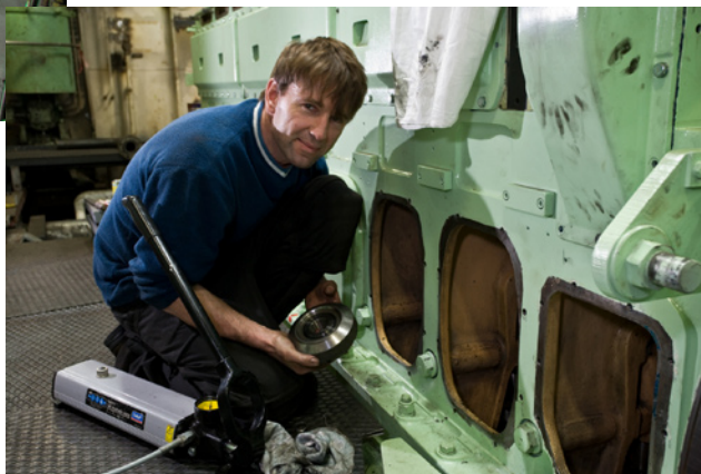
Christof Bartoldi (Zwitserland) werkt aan de bevestiging van de hoofdkogellager in de generator.
